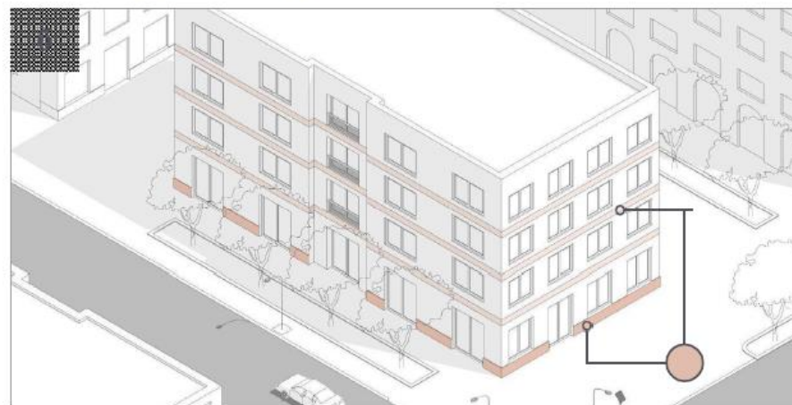
Цоколь в тон перекрытий
